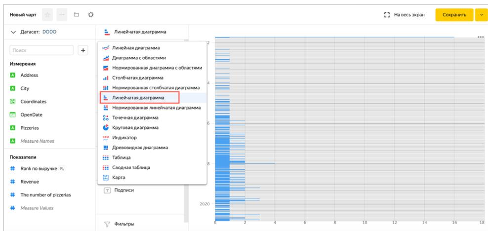
3. Добавьте измерение Pizzerias в секцию Y. Удалите из секции Y измерение OpenDate.
